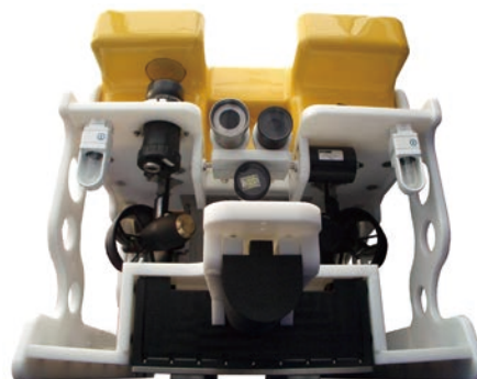
ROV への Sonic2024 艙装例
