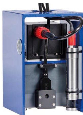
Sonic2020 ソナーヘッド + INS 統合型 IMU
